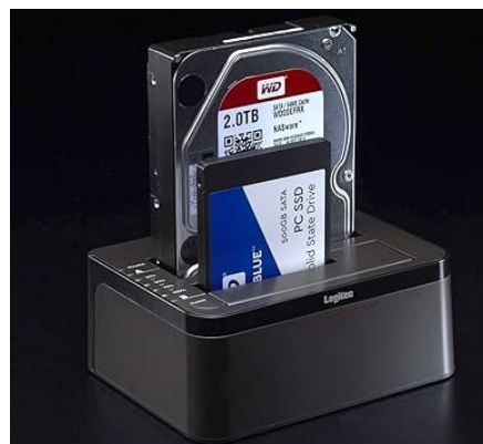
図 18. USB←→SATA 変換ケーブルと HDD スタンド
