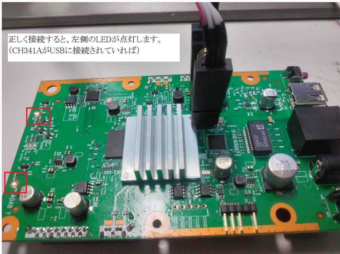
基盤の右側が、LAN 接続インターフェース、電源差込み口、電源ボタン
