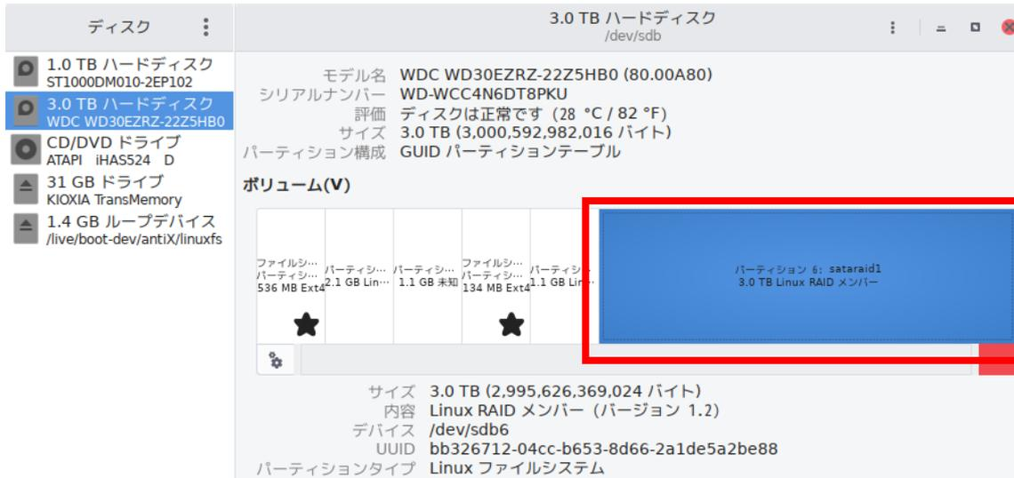
HDL-TA3 のパーティション図です。第 1 パーティション～第 5 パーティションまでの容量と構成は、シリーズで共通です。第 6 パーティションが、データ・パーティションで、HDL-TA1 の場合は 1TB、HDL-TA2 の場合は 2TB、HDL-TA3 の場合は 3TB、HDL-TA4 の場合は 4TB となります。HDD 1 台なのに、「LINUX RAID メンバー」と表示されています。
