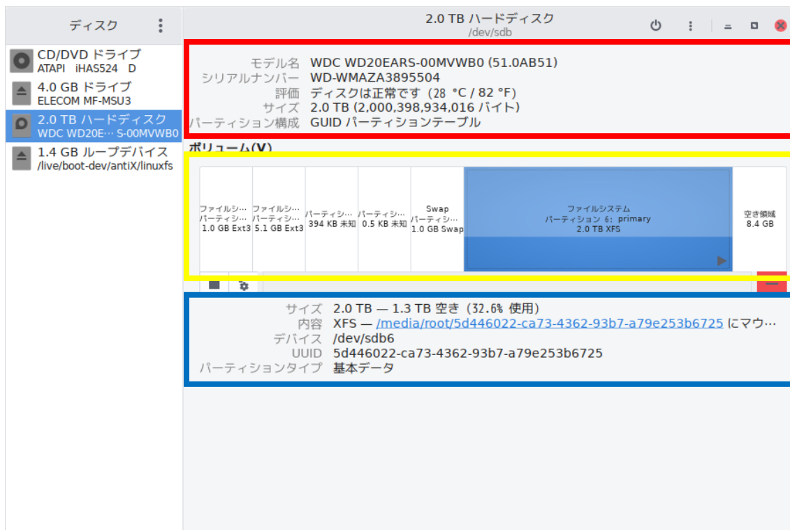
図 13.HDD の詳細と、パーティション図の見方
