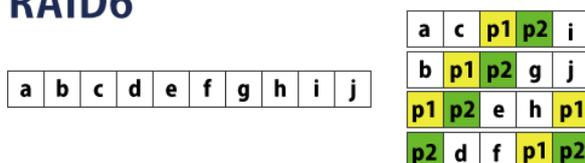
上の図に RAID6 のデータの保存様式を示します。左側はデータ(a~j)を、右側の上下はNASの4台のHDDを模式しています。NASは、2台にブロックを順に書き込んだら、そのパリティ1とパリティ2を残りの2台に保存します。a、b、p1、p2の1列目に注目すると、aのブロックが故障した場合、(bとp1)、(bとp2)、(p1とp2)のいずれかの組み合わせからaを復元することが可能になります。2列目のパリティの位置は、1列目と異なるHDDになります。
