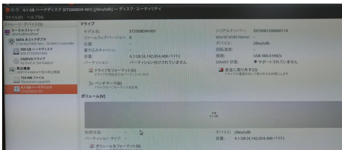
図 6.6.2TB のハードディスクの容量が 4.1GB と表示される
