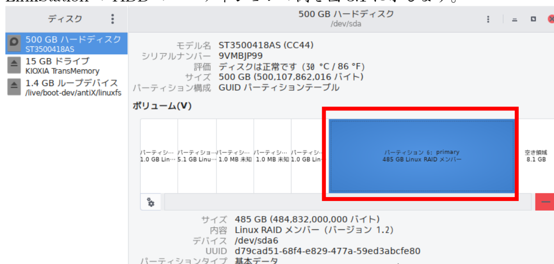
図 3.1. LinkStation の HDD のパーティション図
