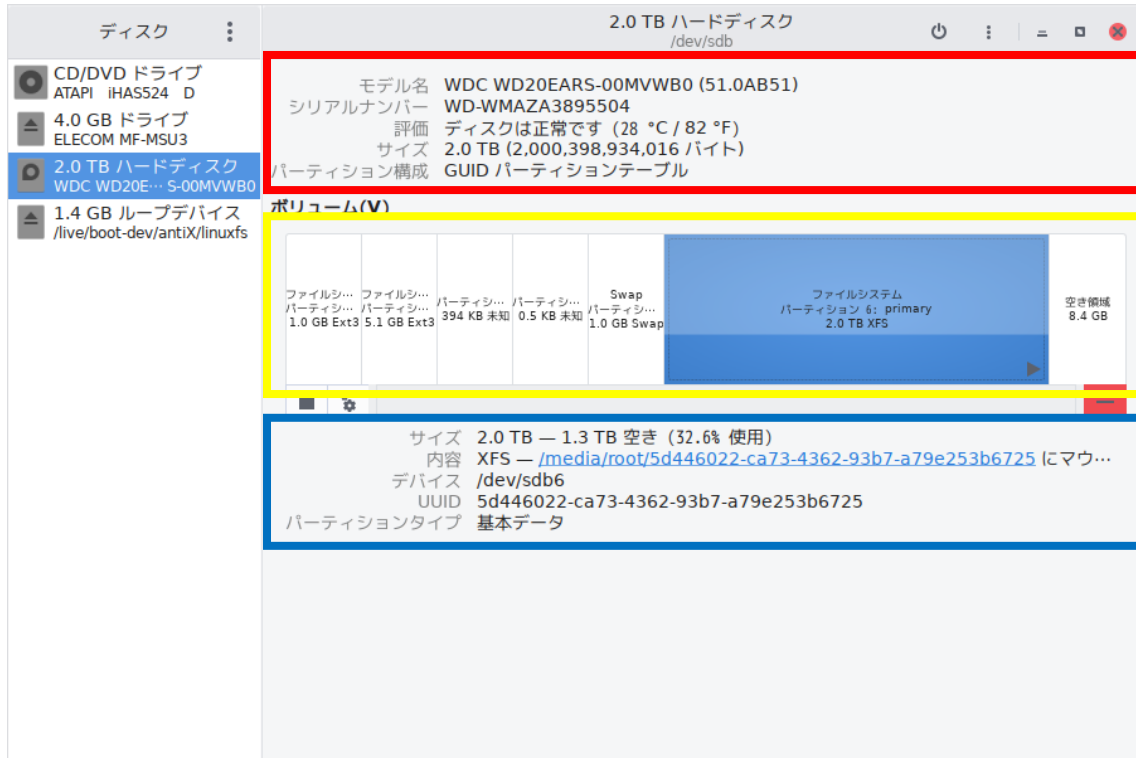
図 6.4.HDDの詳細と、パーティション図の見方
