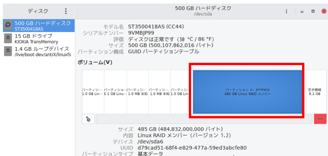
図 3.1. TeraStation の HDD のパーティション図 (XFS ファイルシステム)
