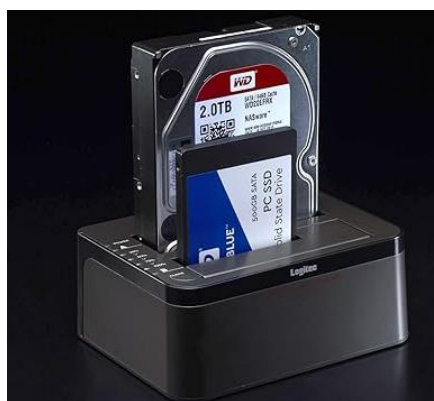
図 5.1 USB \longleftrightarrow SATA 変換ケーブルと HDD スタンド
